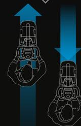
Щёточный узел смещён вбок относительно корпуса машины, для идеальной очистки вдоль стен и уверенности, что весь пол в комнате вымыт.
